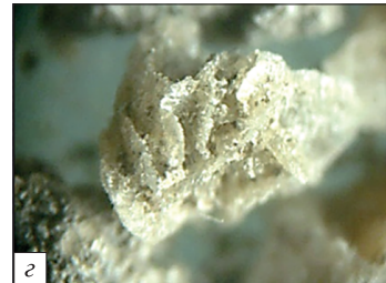
Рис. 1. Агрегати аутигенних мінералів у складі осаду природних і техногенних водойм: a — органічного і хемогенного піриту у глибоководному осаді Чорного моря (гл. 2600 м), колекція акад. Є.Ф. Шнюкова; б — дисконидних кристалів гематиту, шламосховище гірничо-металургійного комбінату «АрселорМіттал Кривий Ріг» (АМКР); гіпсові «троянди» в аловій р. Саксагань ( в ) і Інгuleць ( г ); a — растрова електронна мікроскопія (РЕМ), мікрозондовий аналіз (МЗА); б — електронна мікроскопія, репліка з вилученням; в, г — тринокулярний мікроскоп. Збільшення: б — 15000 × ; в — 80 × ; г — 50 ×
