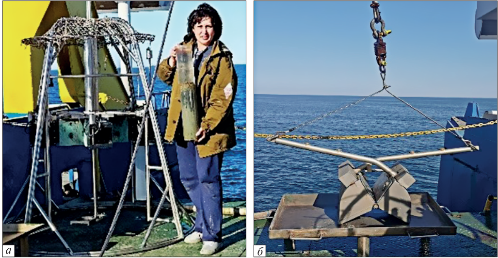
Рис. 1. Устаткування для відбору проб донних відкладів на борту науково-дослідного судна «Mare Nigrum»: а — каркас мультикореру та одна з його секцій; б — черпак Ван Віна
