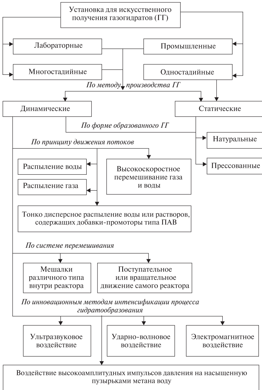
Рис. 12. Классификация технических систем получения газогидрата в лабораторных условиях
