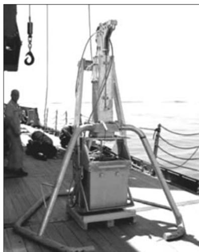
Рис. 6. Пробоотборник типа «Бокскорер»
