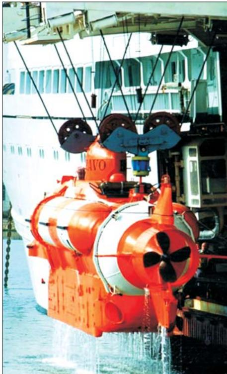
**Фото 4.** Автономный подводный обитаемый аппарат “Браво” на борту НИС “Киев”
