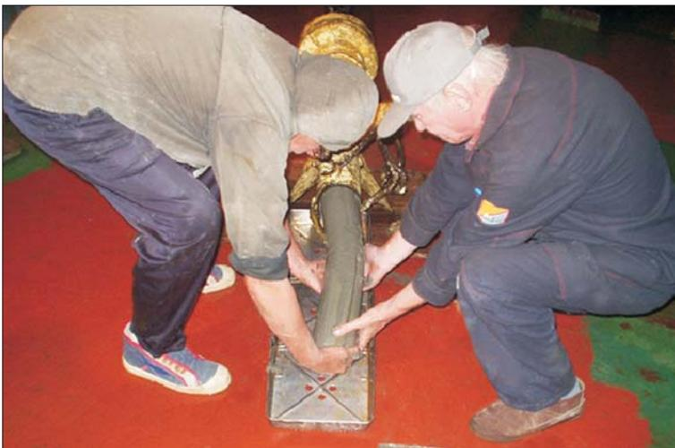
**Фото 10.** Извлечение керна донных отложений из гравитационной трубки
