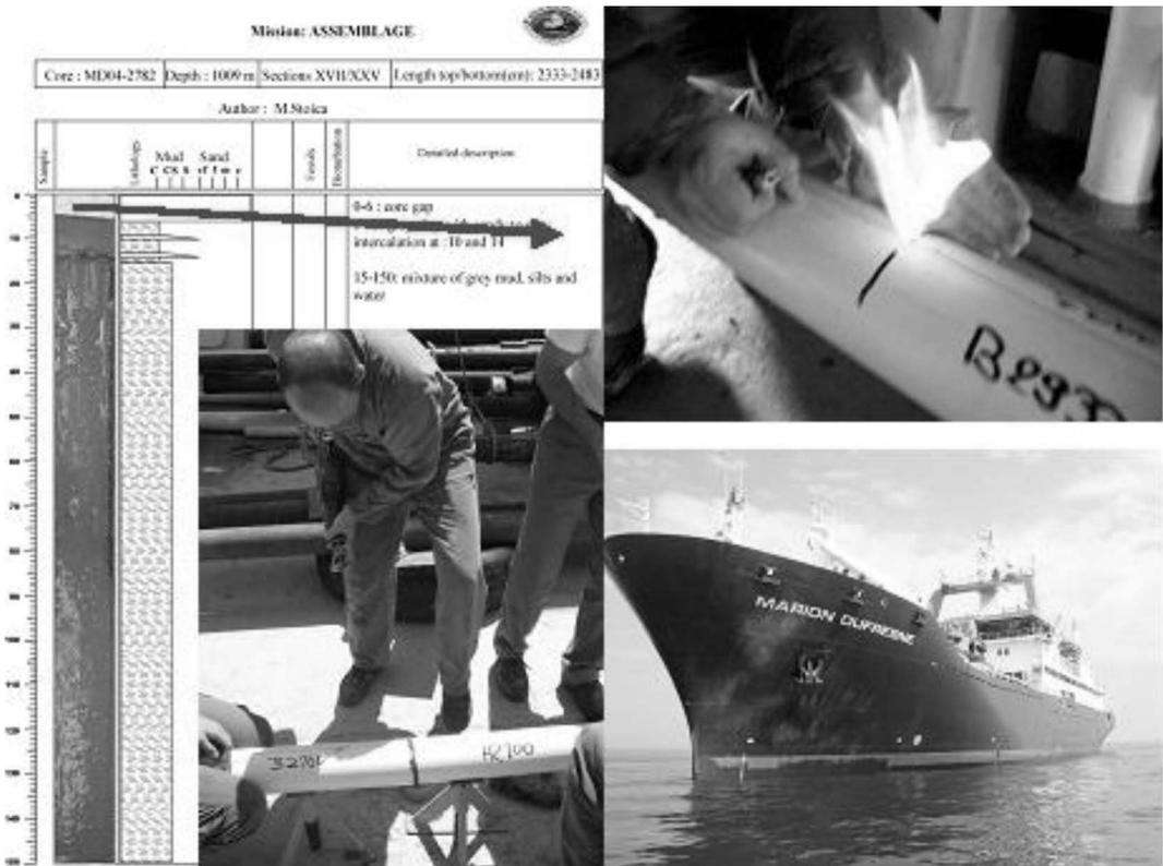
Рис. 3. Описание керна на борту судна. Зажигание газогидратов
