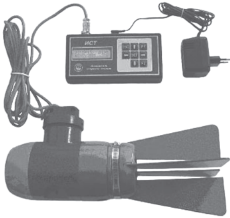
Рис. 5. Внешний вид погружного и бортового блоков ИСТ-1
